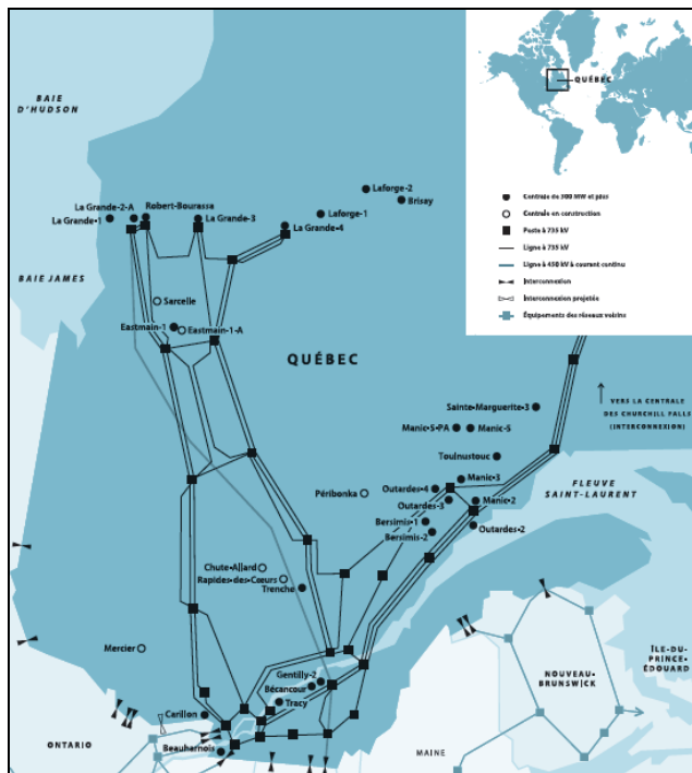
Figure 7 : Les milliers de mégawatts produits au Labrador sont transportés au Québec par le moyen de lignes parallèles qui empruntent la même emprise (image extraite du site web d'Hydro-Québec Transénergie).
